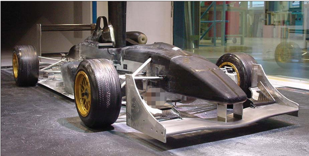
Zweite Phase B05/30 Modelltest im Lola Windtunnel, August 2004 Bildreproduktion oder-transmission ist ausdrücklich untersagt
